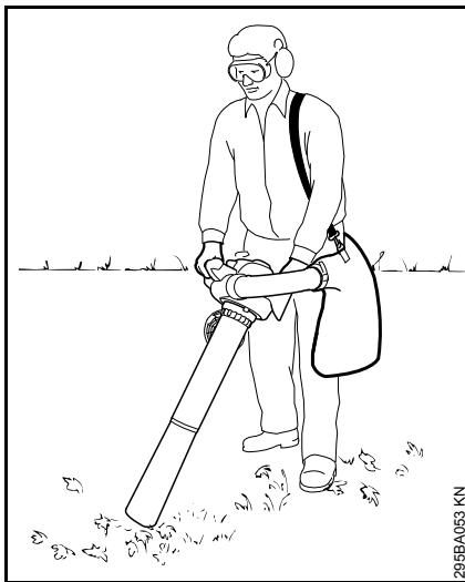
Ο κοπτικός αναρρόφητήρας είναι σχεδιασμένος για να χρησιμοποιείται και με τα δύο χέρια. Πρέπει να μεταφέρεται από τον χειριστή, με το δεξί χέρι στη λαβή χειρισμού και το αριστερό χέρι τη λαβή του περιβλήματος.
