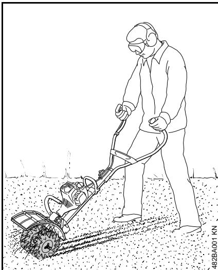
Ο εξαερωτής Multi RL-MM χρησιμοποιείται για τον εξαερισμό χλοοταπήτων (γκαζόν).
