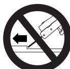
Μην κόβετε λοξά και μη χρησιμοποιείτε τον δίσκο κοπής ως μοχλό.
