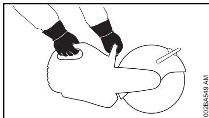
**Κρατάτε το μηχάνημα πάντοτε με τα δύο χέρια:** Το δεξί σας χέρι στην πίσω χειρολαβή, ακόμα κι αν είστε αριστερόχειρας. Για σταθερή καθοδήγηση του μηχανήματος, πιάστε τη σωληνωτή λαβή και τη χειρολαβή γερά με τους αντίχειρες.
