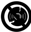
Ελέγχετε τον δίσκο κοπής σε πιο μικρά διαστήματα. Αλλάξτε τον δίσκο αμέσως, αν διαπιστώσετε ραγίσματα, κυρμάσμα ή άλλες ζημιές (π.χ. από υπερθέρμανση) – **Κίνδυνος ατυχήματος λόγω θραύσης!**
