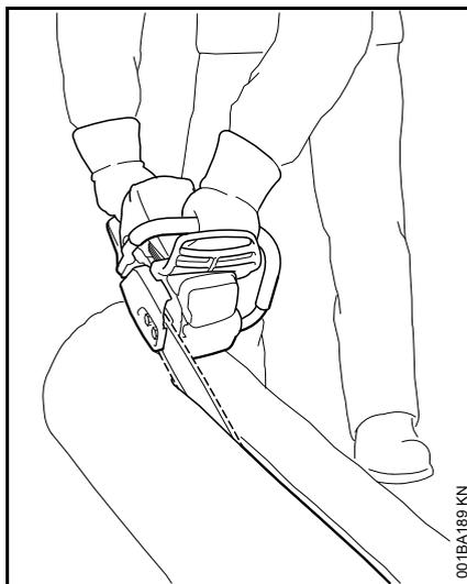
Σ' αυτή την τεχνική κοπής δεν χρησιμοποιούνται τα νύχια στήριξης – **Κίνδυνος τραβήγματος.** Κρατήστε τη λάμα σε όσο γίνεται πιο μικρή γωνία προς το ξύλο και εργαστείτε με μεγάλη προσοχή – **Αυξημένος κίνδυνος κλοσήματος!**
