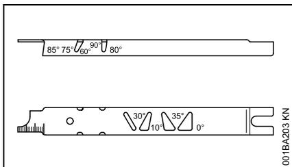
Η καλίμπρα τροχίσματος STIHL (πρόσθετος εξοπλισμός, βλέπε πίνακα «Εργαλεία τροχίσματος») είναι ένα εργαλείο γενικής χρήσης, με το οποίο όχι μόνο μπορείτε να ελέγξετε τις γωνίες τροχίσματος και κλίσης, την απόσταση των οδηγών βάθους, το μήκος των
