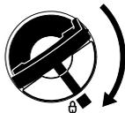
Τάπα με πτυσσόμενο περύγιο (μπαγιονέ): Τοποθετήστε την τάπα σωστά στο άνοιγμα, στρέψτε τη μέχρι τέρμα και κατεβάστε το ασφαλιστικό τόξο.
