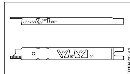
Η καλίμπρα τροχίσματος STIHL (πρόσθετος εξοπλισμός, βλέπε πίνακα «Εργαλεία τροχίσματος») είναι ένα εργαλείο γενικής χρήσης, με το οποίο όχι μόνο μπορείτε να ελέγξετε τις γωνίες τροχίσματος και κλίσης, την απόσταση των οδηγών βάρους, το μήκος των
