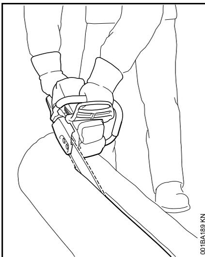
Σ' αυτή την τεχνική κοπής δεν χρησιμοποιούνται τα νύχια στήριξης – **Κίνδυνος τραβήγματος.** Κρατήστε τη λάμα σε όσο γίνεται πιο μικρή γωνία προς το ξύλο και εργαστείτε με μεγάλη προσοχή – **Αυξημένος κίνδυνος κλοσήματος!**
