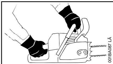
Κρατάτε το αλυσοπρίονο πάντοτε **με τα δύο χέρια**: Το δεξιό σας χέρι στην πίσω χειρολαβή, ακόμα κι αν είστε αριστερόχειρας. Για σταθερή καθοδήγηση του μηχανήματος, πιάστε τη σωληνωτή λαβή και τη χειρολαβή γερά με τους αντίχειρες.
