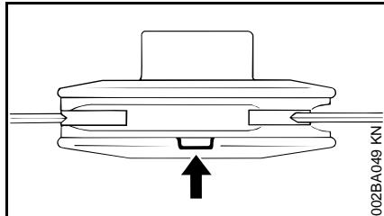
Αν έχει σπάσει κάποιος δείκτης φθοράς σε κεφαλή κοπής PolyCut (βέλος): Μη χρησιμοποιείτε άλλο την κεφαλή κοπής, αλλά αλλάξτε την με καινούργια!
