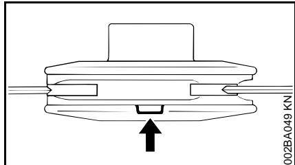
Αν έχει σπάσει κάποιος δείκτης φθοράς σε κεφαλή κοπής PolyCut (βέλος): Μη χρησιμοποιείτε άλλο την κεφαλή κοπής, αλλά αλλάξτε την με καινούργια!
