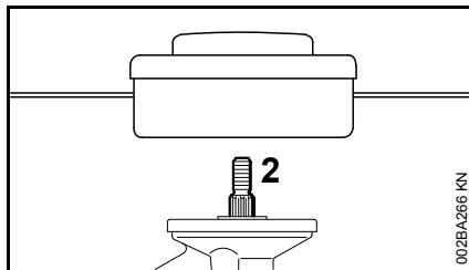
Μπορούν να χρησιμοποιούνται μόνο κεφαλές κοπής που στερεώνονται απευθείας στον άξονα (2).
